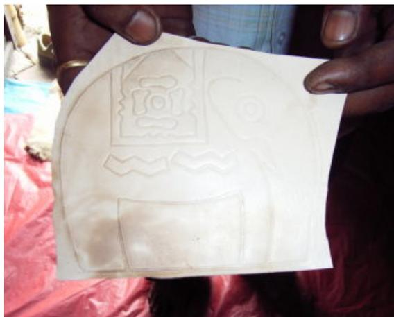
EL PUENTE bezieht von Artisan Well in erster Linie hochwertige Lederartikel. Darunter Portmonees, Taschen, Dekorationsartikel. Die gewünschten Muster und Verzierungen werden mit Blechformen auf das verwendete Rinds- oder Ziegenleder übertragen und mit Hilfe eines Cutters ausgeschnitten. Die dadurch entstanden Einzelteile werden in den nächsten Verarbeitungsschritten geklebt, vernäht und nach abschließender Reinigung fachgerecht verpackt.
